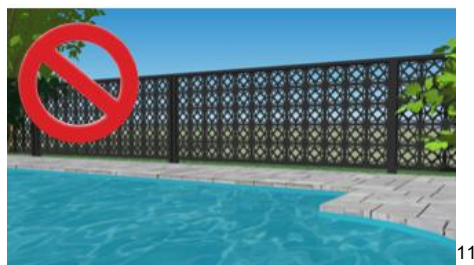
Figure 15 Exemple de clôture dont les travers horizontaux sont trop rapprochés et peuvent être escaladés facilement
