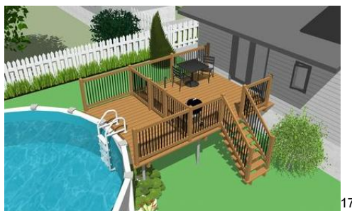
Figure 21 Exemple de terrasse rattachant la piscine à la Résidence. La partie ouvrant sur la piscine est adéquatement protégée par une enceinte
