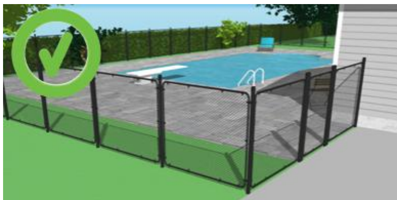
Figure 8 Exemple de clôture en mailles de chaîne dont la largeur est de moins de 30mm
