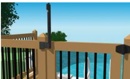
Figure 18 Exemple de loquet pouvant être installé du côté extérieur de l'enceinte, même lorsque celle-ci mesure moins de 1.5m de haut.
