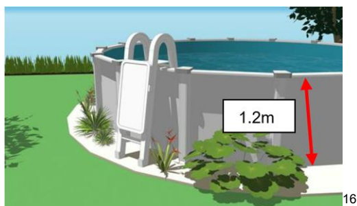
Figure 19 Exemple d'échelle munie d'une portière de sécurité
