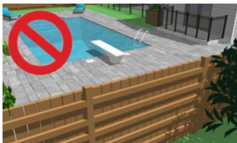
Figure 15 Exemple de clôture dont les travers horizontaux sont trop rapprochés et peuvent être escaladés facilement
