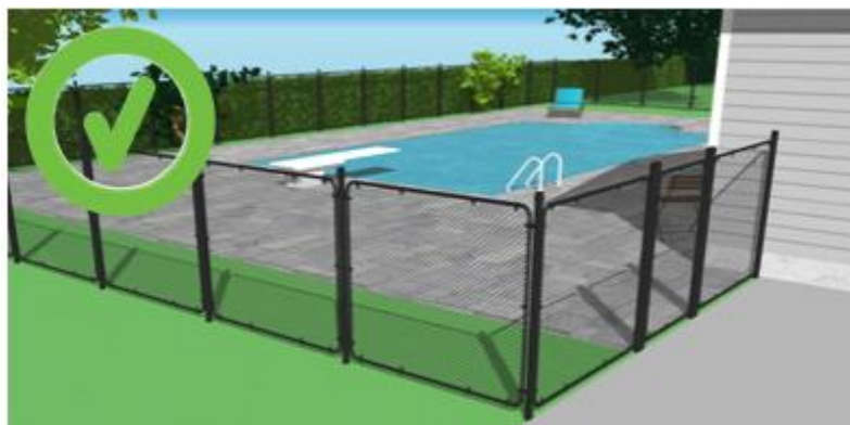
Figure 10 Exemple d'un mur formant une partie de l'enceinte sans ouverture
