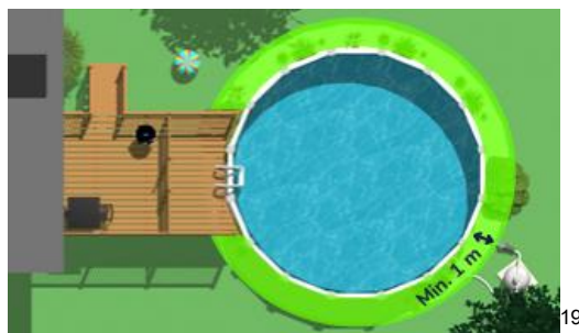
Figure 23 Exemple d'appareils de fonctionnement de la piscine sont situés à plus de 1m de celle-ci
